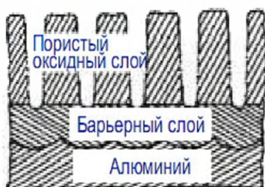
ПОПЕРЕЧНОЕ СЕЧЕНИЕ НЕИЗОЛИРОВАННОГО АНОДНОГО ОКСИДНОГО СЛОЯ
