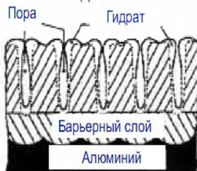
ПОПЕРЕЧНОЕ СЕЧЕНИЕ ИЗОЛИРОВАННОГО АНОДНОГО ОКСИДНОГО СЛОЯ
